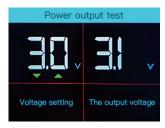
• 0-5V供电功能可以有效助力检查与ECU的接线。在您使用电压表或欧姆表检查传感器后,如果仍然存在问题,您可以模拟传感器输出的电压以验证去往ECU的接线,使用OBD扫描仪可以查看ECU的检测结果。设备可以选择从0~5V的供电电压(电流<100mA),以0.5V为增量。界面显示分为2个部分,左边的显示设置的电压(使用"上键"和"下键"按键来增加或者减小电压的设置值),右边显示实时采样电笔探头输出的电压值。具有一个设定点电压警报,以防连接到探头尖端的电路会迫使电压高于或低于设定点。电压为0.1V,设备将会响起警报声以便清楚输出电压与设置电压之间存在差异,可断开并检查电路是否出现短路或其他故障。
