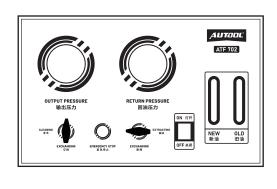
用电夹连接汽车蓄电池(红色电夹连接正极,黑色电夹连接负极),将透明连接管连接出油管,开启电源开关,直至有新油流出(此步骤可以排出机器内部空气)。
