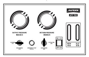
● 启动汽车发动机(清洗时设备电源不用打开),此时本机处于循环清洗状态,可从新旧油视窗观察到油的流动。在清洗过程中,每个档位循环切换停留5-10秒,5分钟后完成清洗,可以关闭发动机。
